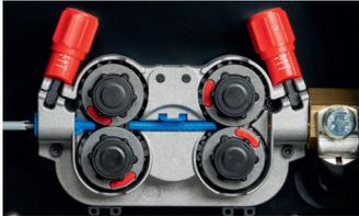
Un robusto mecanismo de tracción en las cuatro ruedas que dura en las condiciones más extremas y una velocidad del cable que oscila entre 1,3 y 20 metros por minuto.
