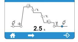
Miller 4Ts Triggerfunktionalität -Ermöglicht Ihnen den Zugrifft auf Heißstart oder Kaltstart direkt vom Brennertaster aus.
