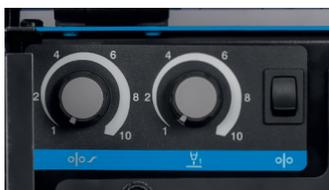
**Funzioni run-in e bun-back regolabili** consentono all'operatore di impostare il parametro ottimale per l'innesco e lo spegnimento dell'arco, riducendo così l'impuntamento o la fusione del filo sul puntale della torcia.
